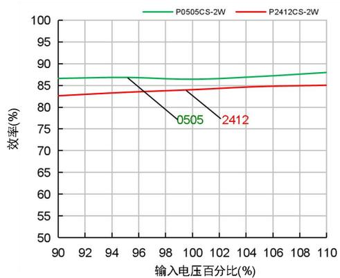
效率与输入电压关系曲线图(满载)
