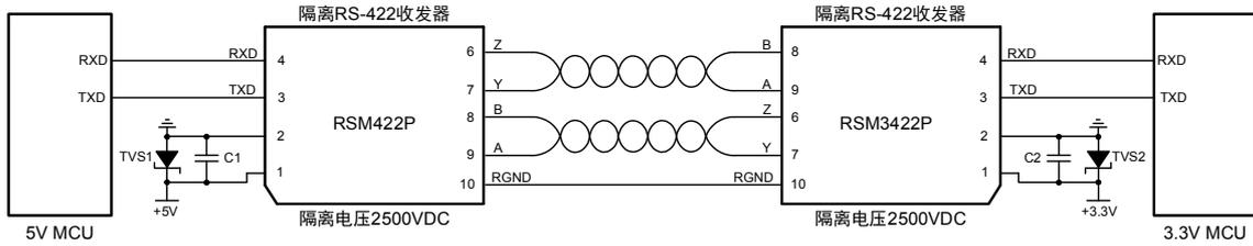
图 1 点对点连接电路图
