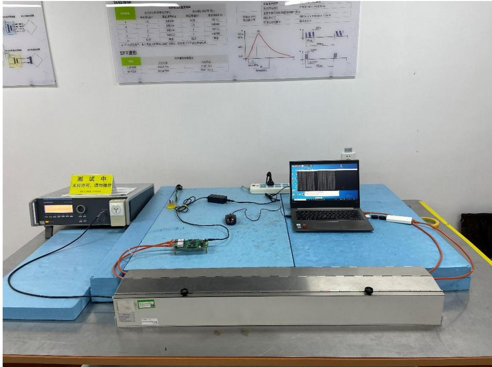
图 3 EFT 试验配置
