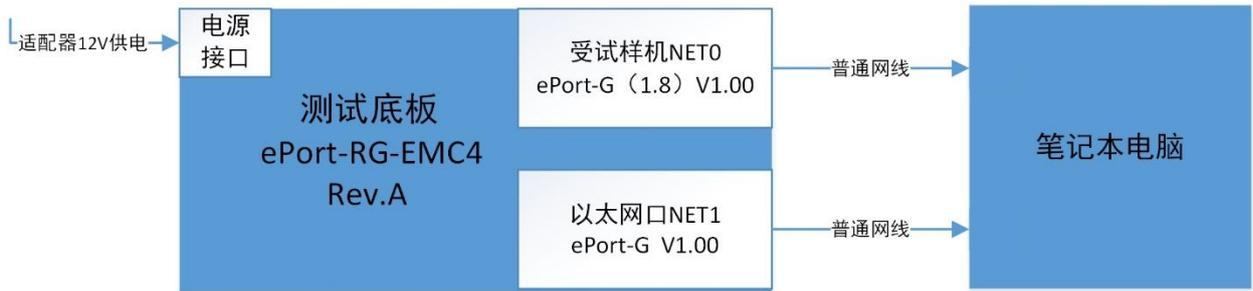
图 2 ESD 试验配置示意图
