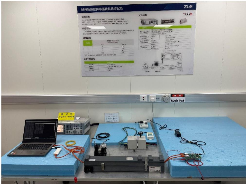
图 5 CS 试验配置
