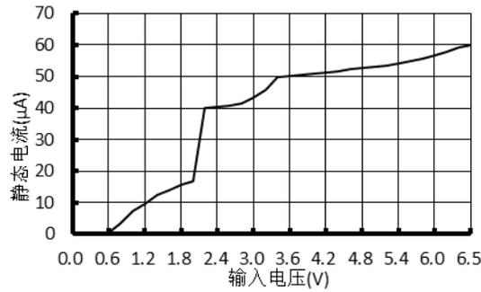
图3 静态电流特性曲线
