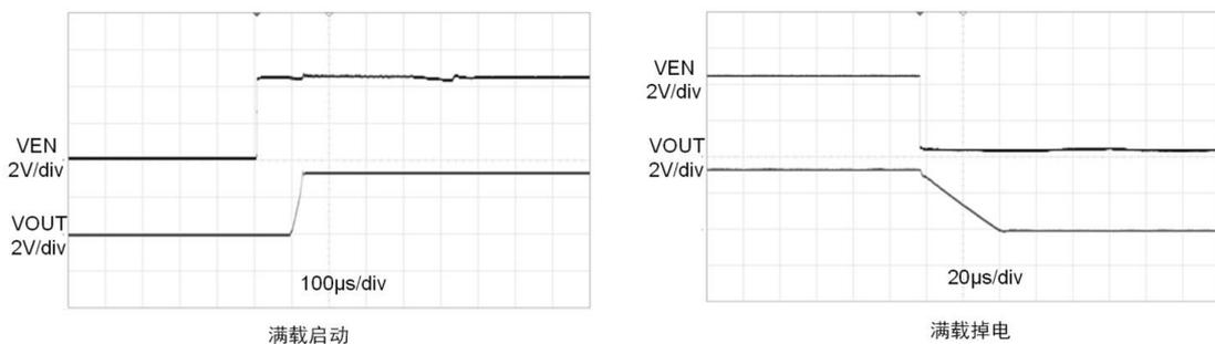
图5 满载下快速启动与快速掉电
