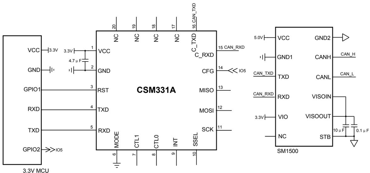
图 8 UART 转 CAN 参考电路
