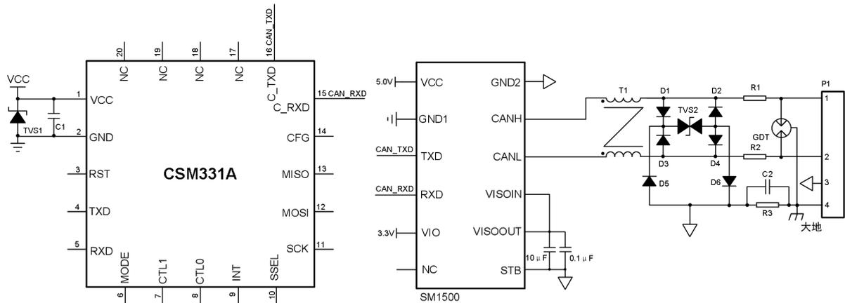
图 11 外围保护电路 2
