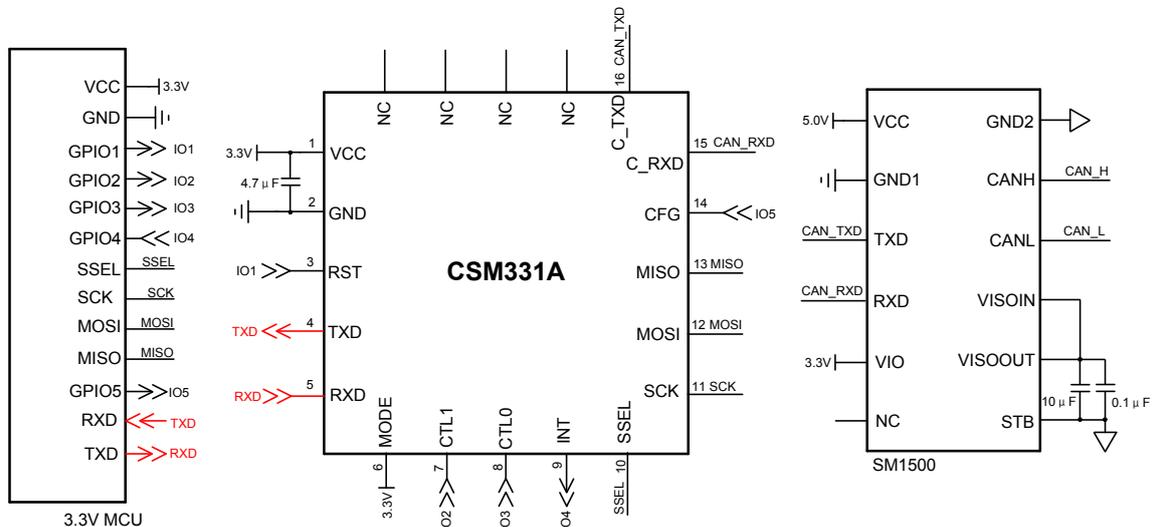
图 7 SPI 转 CAN 带错误反馈机制参考电路
