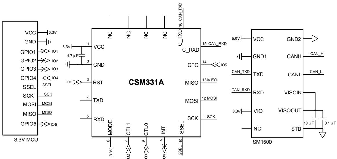
图 6 SPI 转 CAN 参考电路
